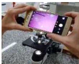
Utilização do celular com o dispositivo Med Eyes no microscópio.
