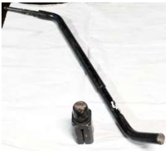
Figura 4 – Alavanca de engate fratura nos testes de rodagem.
