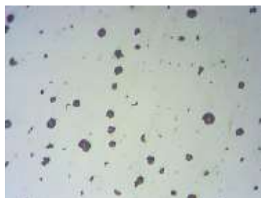
Microscopia óptica, sem ataque com aumento 400 X, austenitizada a 900 °C por 1h, temperada em óleo e revenida a 480 °C por 2h
