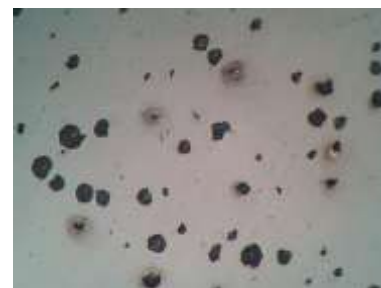
Microscopia óptica, sem ataque com aumento 400 X, austenitizada a 900 °C por 1h e recozida no forno
