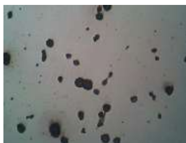
Microscopia óptica, sem ataque com aumento 400 X, austenitizada a 900 °C por 1h e normalizada ao ar
