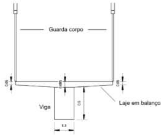
Figura 4 – Detalhamento dos trechos: L3, R3, L2, R2, L1, R1
