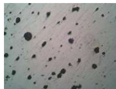
Microscopia óptica, sem ataque com aumento 400 X, austenitizada a 900 °C por 1h e austemperada a 400 °C por 2h
