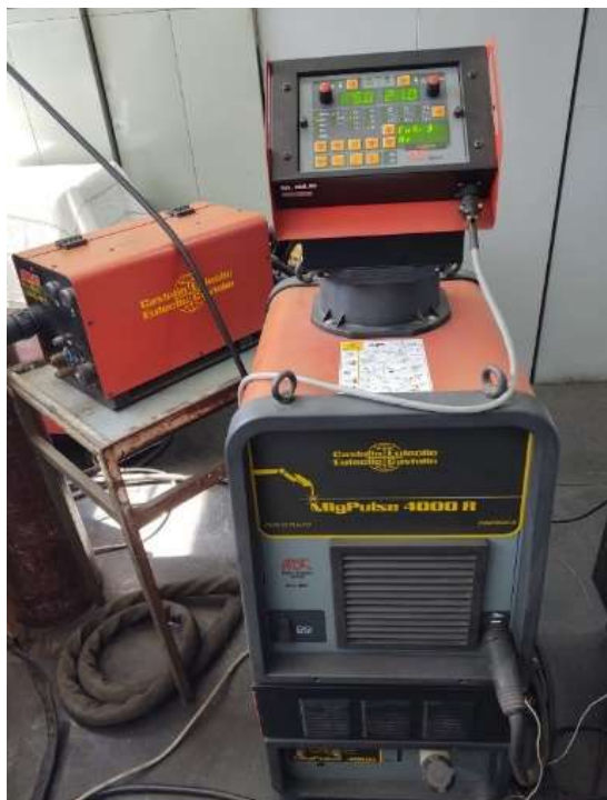
Figura 10 - Equipamento de soldagem MIG utilizado para brasagem
