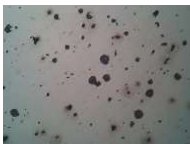
Microscopia óptica, sem ataque com aumento 400 X, ferritizada a 760 °C por 5h
