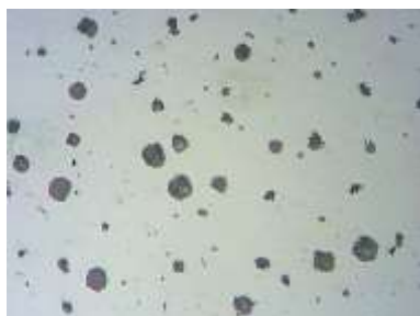
Microscopia óptica, sem ataque com aumento 400 X, como recebido
