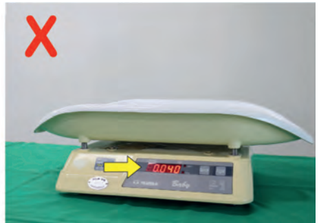
Figura 8 – Diferença entre tara correta e errada de balança
