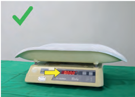
Figura 8 – Diferença entre tara correta e errada de balança
