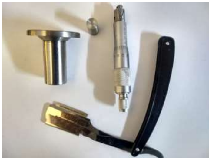
Figura 5 – Partes do Micrótomo
