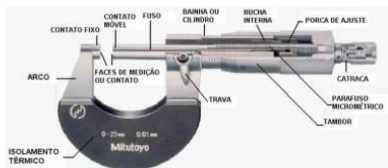
Figura 4 – Micrômetro e suas partes
