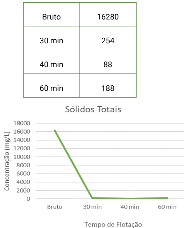
Figura 4 – Concentração de sólidos totais em função do tempo de eletroflotação. Corrente e tensão aplicada de 0,28A e 11V respectivamente.
