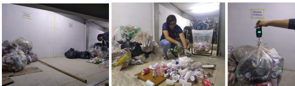
Figura 3 – a) Separação dos materiais conferidos e não conferidos; b) Conferência dos materiais; c) Análise gravimétrica.
