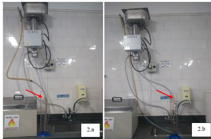
Figura 3- Medição de vazão/ litro em água destilada e água de torneira. Fig 2.a, vazão da água da torneira desprezada por litro. Fig 2.b, vazão da água destilada por litro
