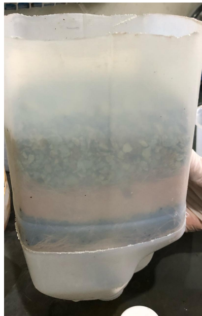
Figura 9 - Filtro utilizado para remoção de metal pesado. De baixo pra cima: carvão ativado, resina catiônica e zeólita.
