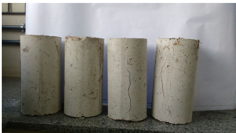
Figura 4 – Corpos de prova com 1% de fibra após ensaio de tração por compressão diametral
