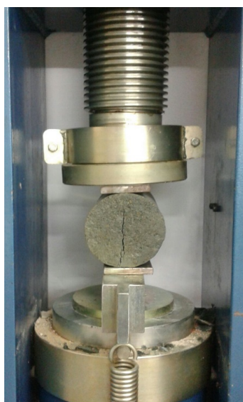
Figura 2 – Ensaio de tração por compressão diametral em corpo de prova de concreto simples
