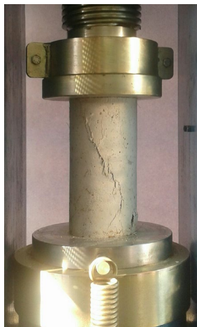
Figura 1 – Ensaio de compressão em corpo de prova com 1% fibra de coco.
