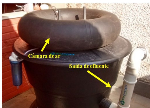
Figura 1: Protótipo biodigestor anaeróbio
