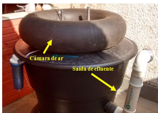
Figura 1: Protótipo biodigestor anaeróbio
