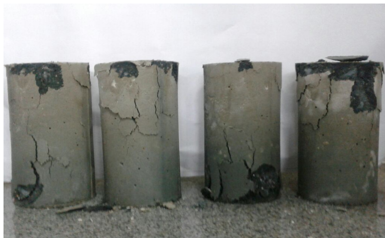
Figura 3 – Corpos de prova de concreto simples após rompimento em ensaio por compressão
